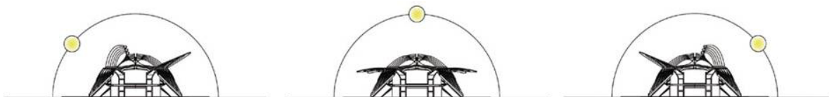
FIGURA 10 - O edifício “vive” através do movimento das aletas laterais.
